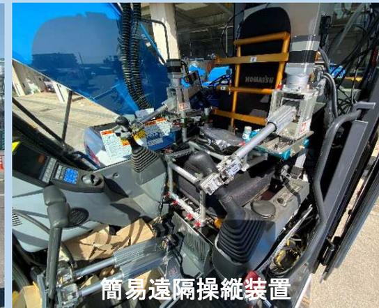
簡易遠隔操縦装置
